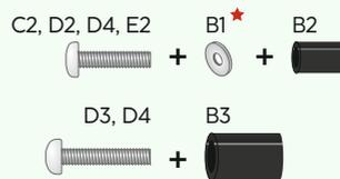
★ Para os parafusos D, não são necessárias anilhas planas
