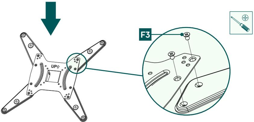
Montieren Sie die mitgelieferten Adapterplatten auf der Rückseite der VESA-Platte mithilfe von Schrauben [F3].
