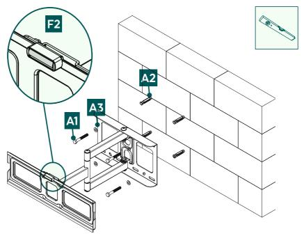
• Bringen Sie die Wandhalterung, wie oben gezeigt, mithilfe von beiliegendem Montagematerial ([A2] Dübel, [A3] M8 Beilagscheibe, [A1] 6x55 mm Schraube und [F2] Wasserwaage) an der Wand an.
