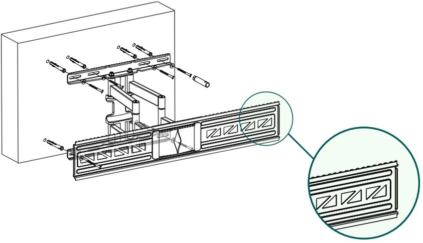
Antes del montaje, asegúrese de que el lado ranurado de la placa VESA esté orientado hacia arriba.
