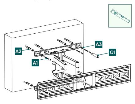
• Montare il supporto alla parete come sopra illustrato utilizzando il materiale di montaggio in dotazione ([A2] tassello, [A3] rondella M8, [A1] vite 8x60 mm, [G1] chiave a tubo e [F2] livella).
