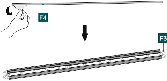
Retire la lámina del relleno de espuma [F4] y fíjelo a los lados de los dos brazos VESA.
