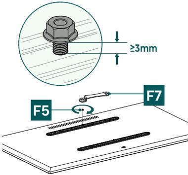
Pri nasledujúcom montážnom kroku si zabezpečte podporu a pomoc od iných ľudí. Počas inštalácie musia byť spoje nastavené tak, aby bol možný bočný pohyb televízora.
