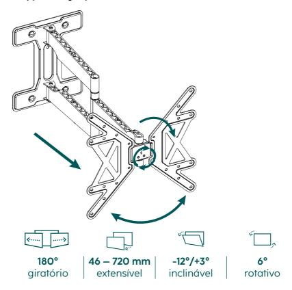
Para o ajuste da inclinação, solte os parafusos de fixação laterais, ajuste a inclinação pretendida e volte a fixar os parafusos em segurança.
