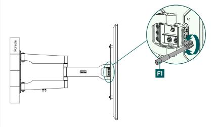
• Em seguida, aperte os parafusos de fixação laterais com a chave de boca para tubos [F1] fornecida.
