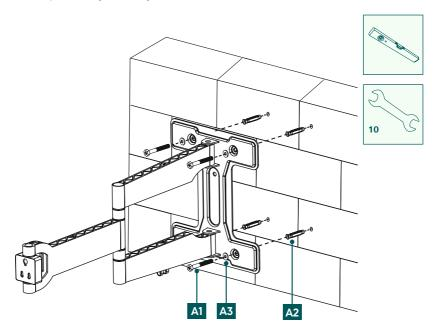
• Fixe o suporte de parede à parede, como indicado acima, utilizando o material de montagem fornecido ([A2] bucha, [A3] M8 anilha plana, [A1] parafuso 8x60 mm e [F2] nível de bolha).
