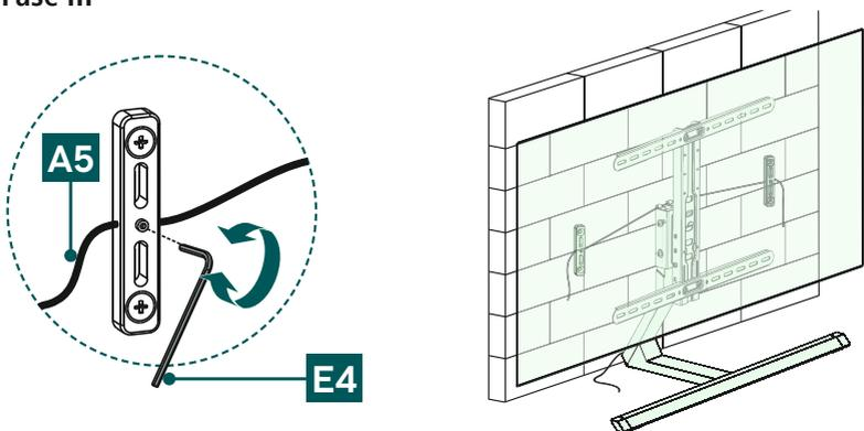
Far passare il cordino [A5] attraverso i due elementi di fissaggio montati alla parete. Assicurarsi che il cordino sia teso e fissarlo con la chiave a brugola [E4] come sopra illustrato.
