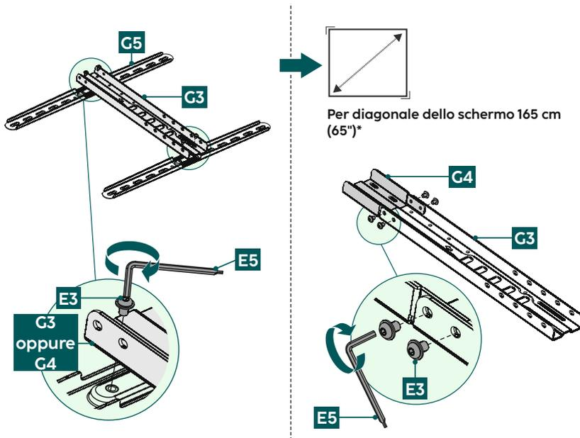
A seconda delle dimensioni del televisore, montare i bracci VESA [G5] sul montante [G3] o sulla piastra di adattamento [G4] utilizzando le viti [E3] e la chiave a brugola [E5] in dotazione.
