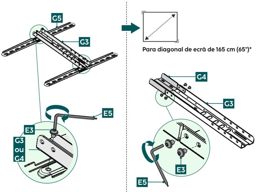
Monte os braços VESA [G5] na trave [G3] ou na placa adaptadora [G4] utilizando os parafusos [E3] e a chave Allen [E5] fornecida, consoante o tamanho do televisor.
