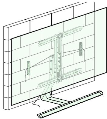
Passo o fio [A5] pelas duas peças de fixação montadas na parede. Certifique-se de que o fio está esticado e fixe-o com a chave Allen [E4], como ilustrado acima.
