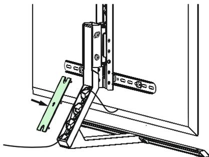
Coloque os cabos ao longo da perna de apoio, como indicado na ilustração. Em seguida, volte a colocar a tampa [G7] no pé de suporte.
